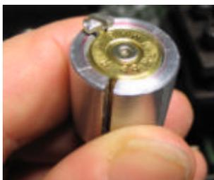
A gauche: introduction de la douille dans l'outil, la vis de verrouillage est en position "ouverte".
