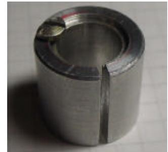
Avant montage de la douille dans l'outil, modifier l'épaisseur du culot de celle-ci si nécessaire (il faut généralement réduire l'épaisseur du culot de la douille de quelques dixièmes de millimètre).
