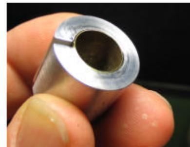
Déverrouillage et sortie de la douille de l'outil, ébavurage.
